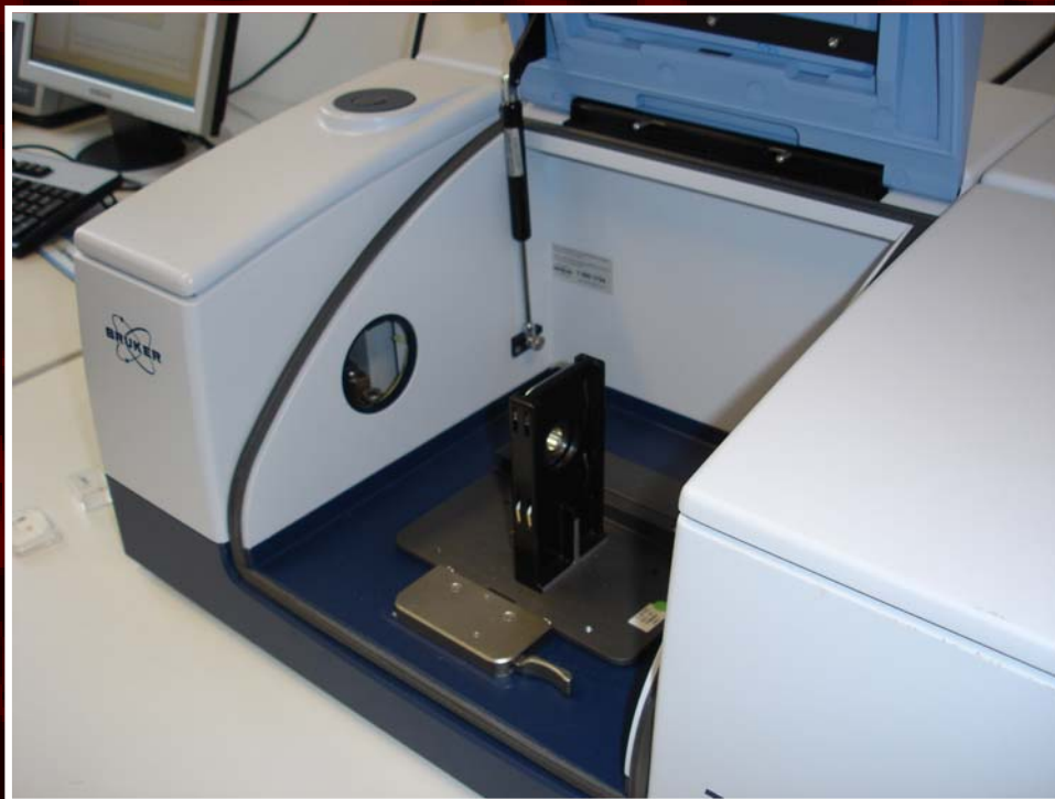
Komora s úchytem pro nosiče se vzorkem
