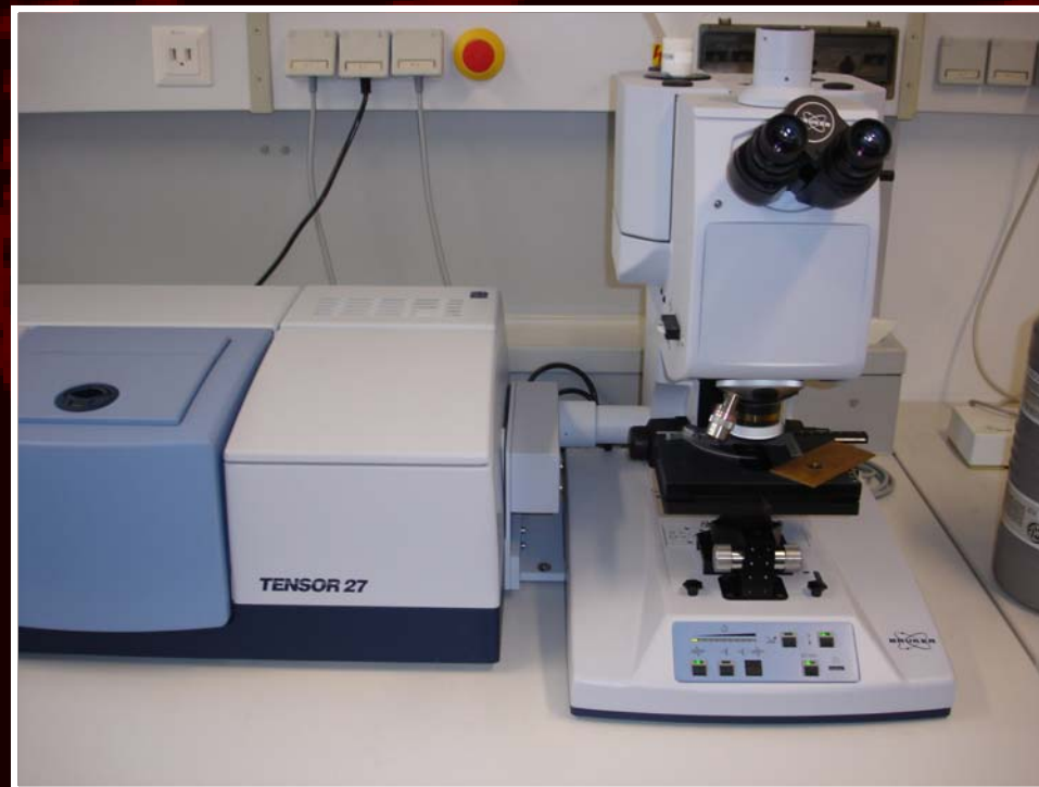
IR-mikroskop připojený k IR-spektrometru
