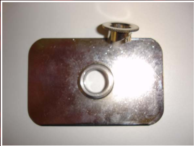
Nosič kruhových clonek se vzorkem - dimenzován i na průměr KBr tablet
