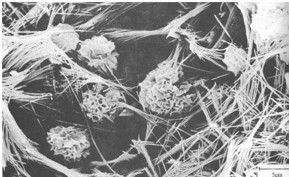
SEM mikrofotografie vláken krystalů mordenitu s oválnými shluky smektitů
