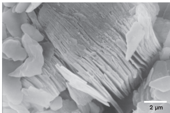
Obrázok 4.2 SEM fotografia vermikulárneho kaolinitu, vzniknutého ako pseudomorfóza po slude (prevzaté z práce Kraus, 1989).
