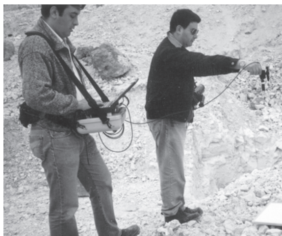
Obrázok 8.8 Kalibrácia IČ detektora pre blízku IČ oblasť používaného pre letecký prieskum na ložisku hydrotermálneho kaolinitu v oblasti Combarbala, Chile.
