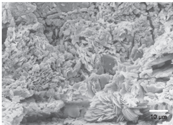
Obrázok 8.23 SEM fotografia dokumentujúca existenciu dvoch generácií častíc kaolinitu v hydrotermálnom kaolíne z lokality Čičava.
