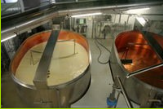
Sýrařské kotle s harfami
