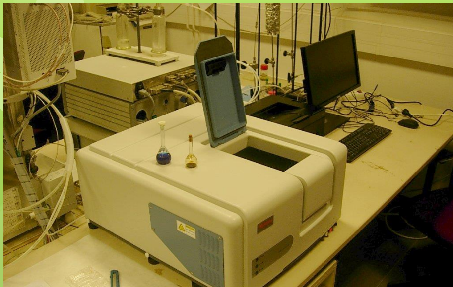
Spektrometr Lumina: cela pro kapalné a práškové vzorky. Pro studium koloidních roztoků nanočástic a kvantových teček (QDs)
