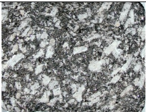
lineárně paralelní protažení porfyrických vyrostlic např. syenit
