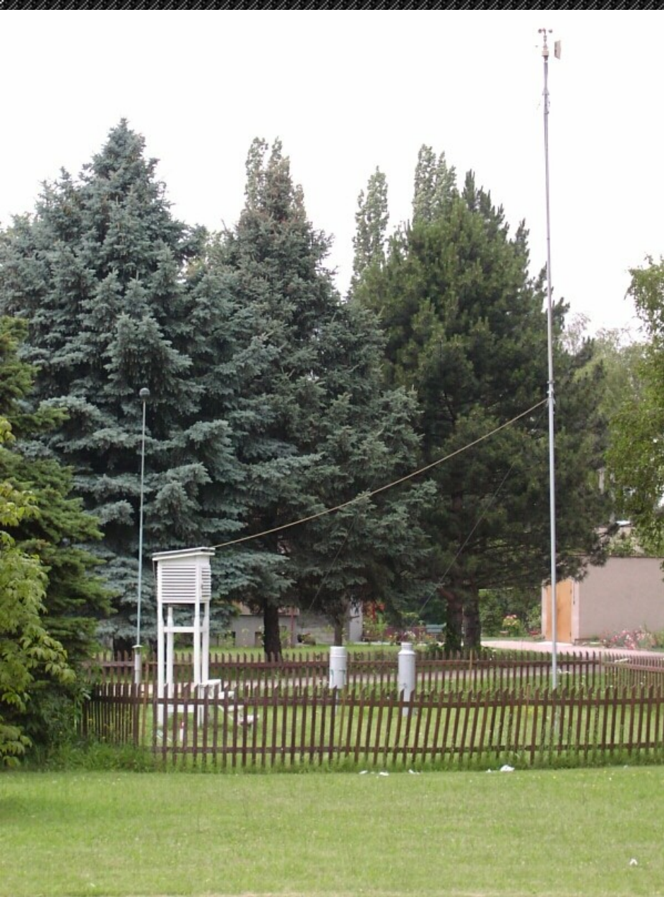
Obr. 3. Standardní meteorologická stanice (ČHMÚ, 2014)
