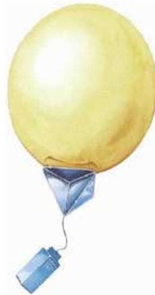
Obrázok 1.3 Rádiosonda – balón na aerologické meranie
