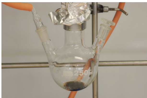
Obr. 2: Rozložený polystyren (destilační baňka)
