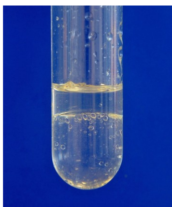
Obr. 5: Reakce styrenu s \text{H}_2\text{O}
