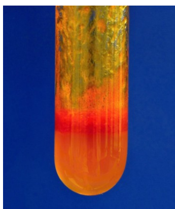
Obr. 4: Reakce styrenu s \text{H}_2\text{SO}_4
