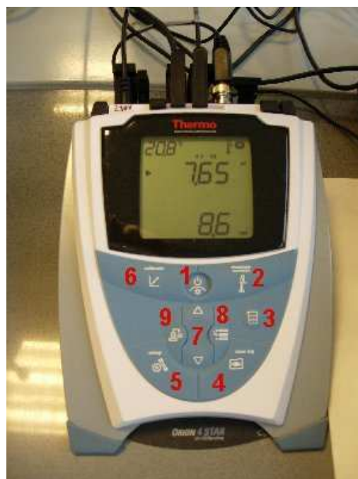
Obr. 1.: Základní funkce a rozvržení kláves přístroje. 1...Zapnutí, vypnutí a osvětlení displeje. 2...Měření. 3...ovládání míchadla. 4... Prohlížení dat. 5...vstup do režimu nastavení přístroje. 6...kalibrační režim. 7... posuv v nabídce. 8... výběr řádku na displeji. 9...horizontální výběr pozice.
