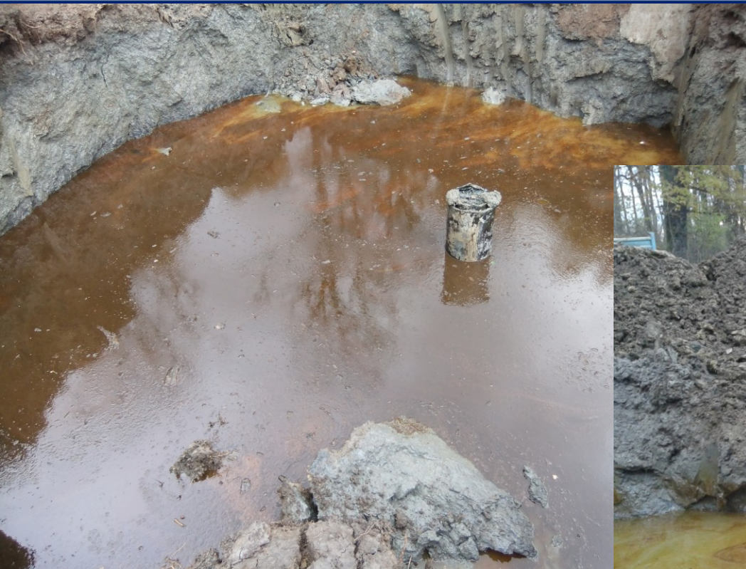
Sonda KO7-masivní kontaminace podzemní vody volnou fází RL
