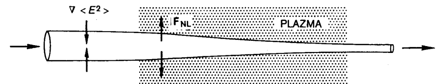
Samofokuse laserového svazku je způsobena ponderomotorickou silou. OBR. 8-12
