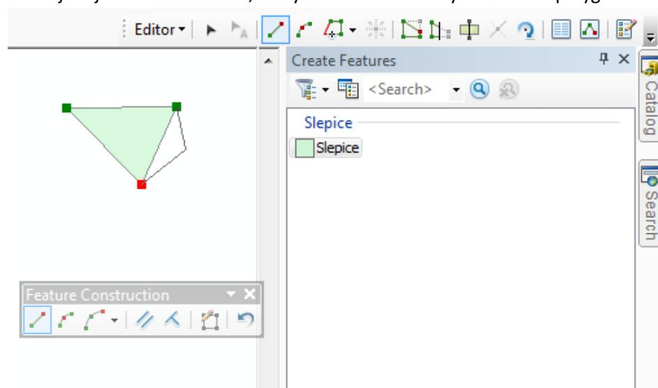
V nabídce Feature Construction, která se objeví při kreslení nových tvarů, nebo též na liště Editing najezněte mj. tlačítko pro rovný segment, pravý úhel, kruhovou výseč i úseč, Bezierovu křivku, průsečík nebo též tzv. **Trace Tool**, pomocí něhož lze obkreslit i jiné téma, než je právě editované (musí být ale vybrané). Na liště se nachází i jiné praktické nástroje:
