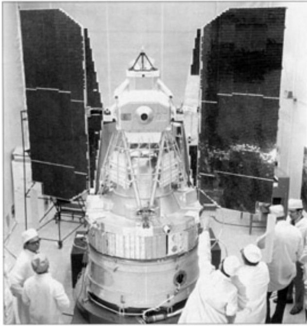
Obr. Družice Landsat-1. První generace tvořená družicemi Landsat 1, 2 a 3 byla konstrukčně odvozena od meteorologických družic Nimbus. Zdroj: NASA
