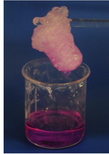
Obr. 3.3: Produkt vzniklý neřízenou polymerací
