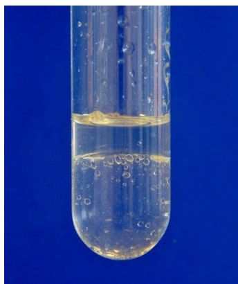
Obr. 8.5: Reakce styrenu s H_2O
