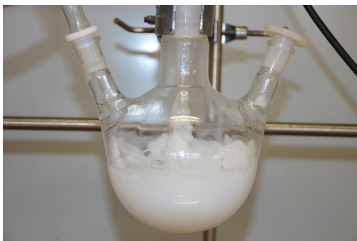
Obr. 5.3: Nežádoucí výsledek polymerace vypnuté v průběhu reakce
