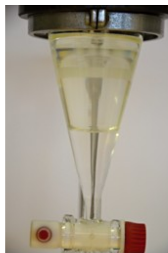
Obr. 4.1: Oddělené fáze při čištění styrenu
