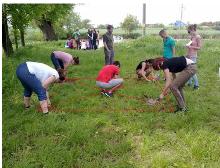
Obrázek 4: Vzorkovací síť pro odběr vzorků půd
