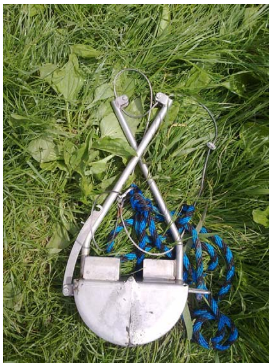
Obrázek 3: Drapák pro vzorkování sedimentu
