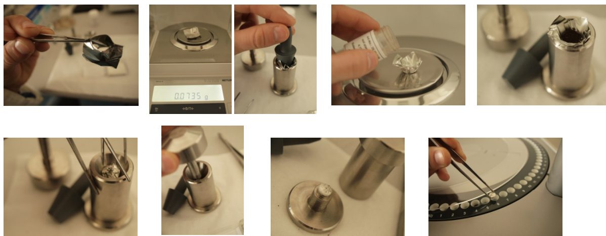
Obrázek 11: Příprava vzorku pro stanovení TC a TOC
