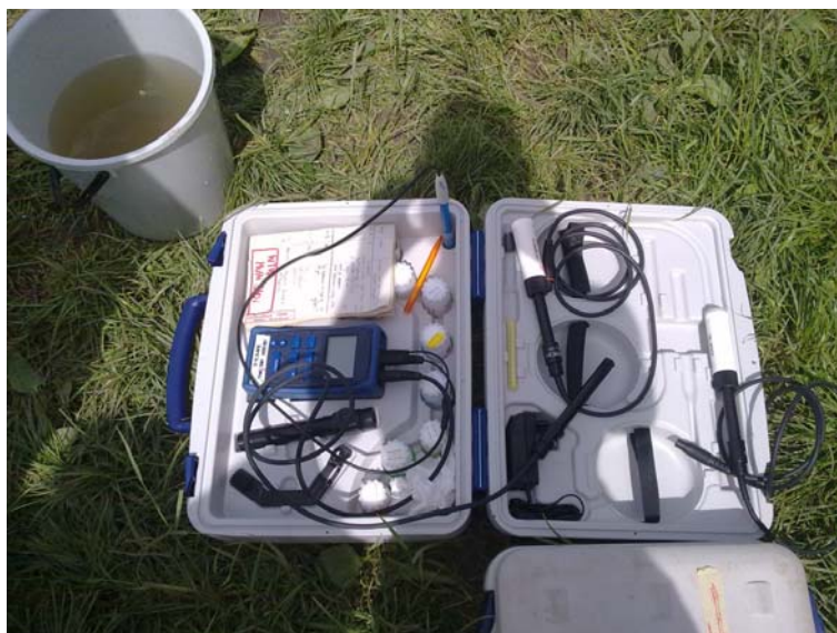
Obrázek 7: Souprava pro měření základních parametrů vzorků vod
