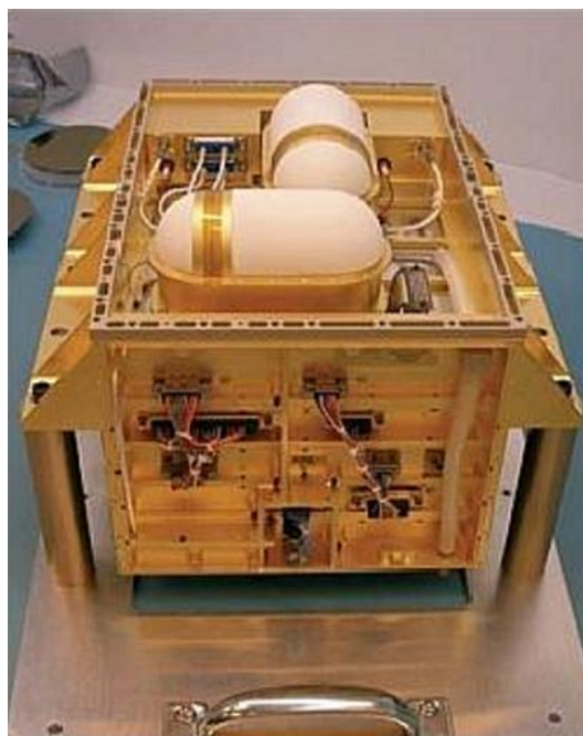
Obr. 24 Zařízení EFI (nahore dva ortogonální senzory)
