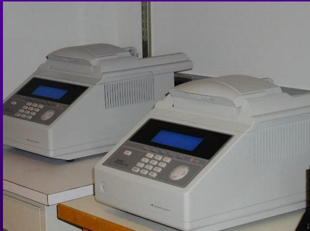
Termocyklery dokáží automaticky rychle měnit teplotu v reakčních blocích mezi třemi základními teplotami PCR cyklu
