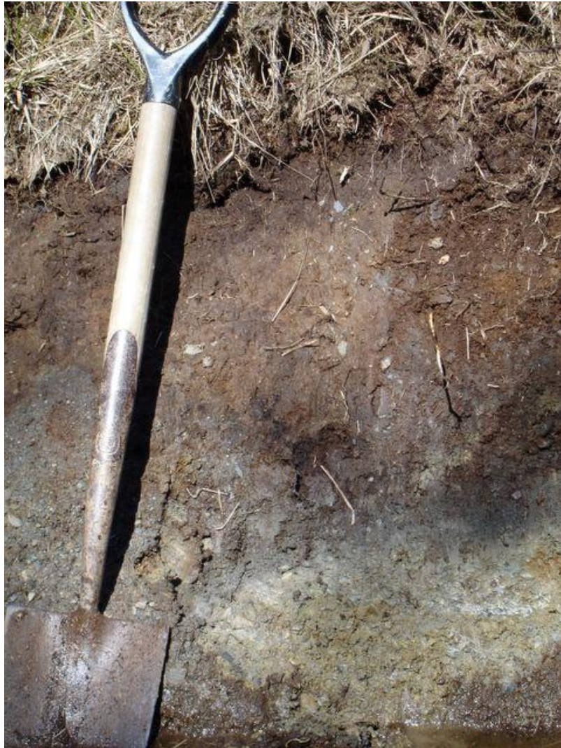
Stagnohumic gley soil in upland Wales (UK), foto: Richard Hartnup (Pseudogley, surface-water gley) Stagnohumická glejová p da%ve vyzřích polohách Walesu (Velká Británie): razelinný svrchní horizont, pod ním sled horizont typický pro pseudogleje (stagnogleje%dle britské terminologie).
