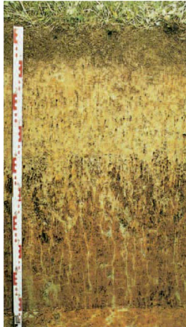
Pseudoglej ze sprazové hlíny: Sv tlá vrstva s ernými, tvrdými, kulatými konkracemi v svrchní ásti p dního profilu indikuje st ídání vysychání a zamok ení; rezavé zbarvení a zedé mramorování jsou charakteristické pro hutnou spodní vrstvu nepropustnou pro vodu.
