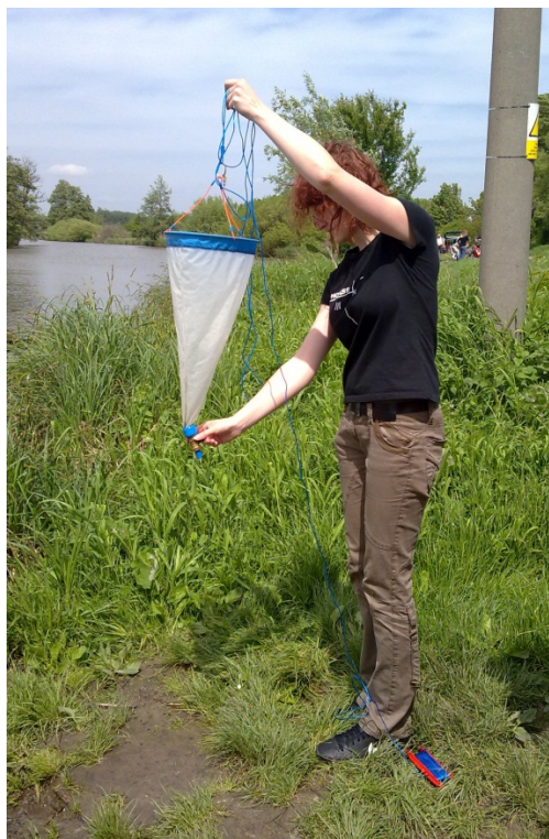
Obrázek 6: odběr zooplanktonu a fytoplanktonu pomocí planktonní sítky
