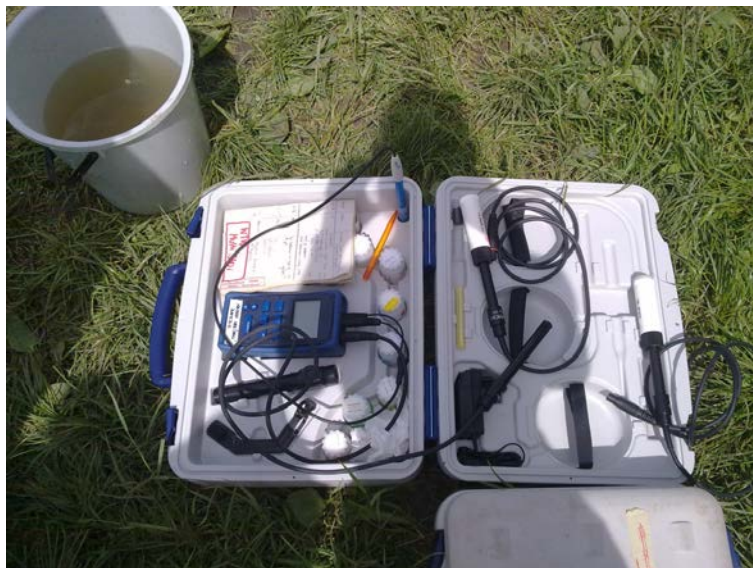
Obrázek 7: Souprava pro měření základních parametrů vzorků vod
