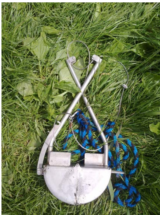
Obrázek 3: Drapák pro vzorkování sedimentu
