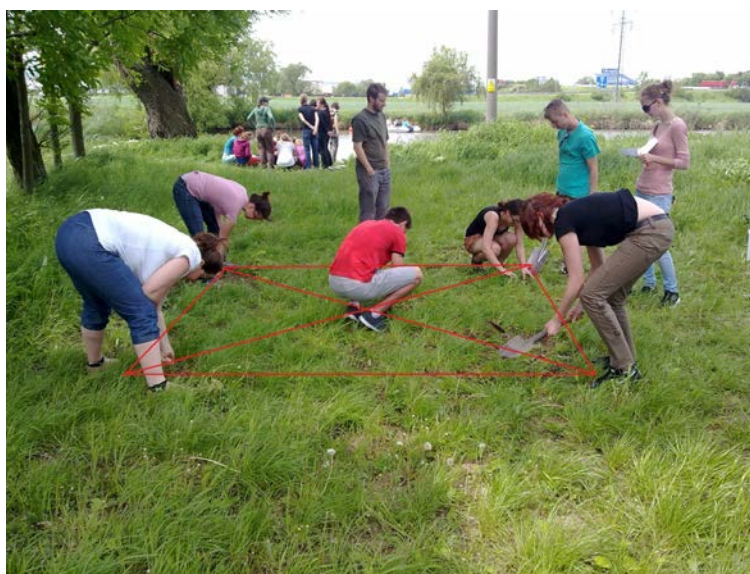
Obrázek 4: Vzorkovací síť pro odběr vzorků půd
