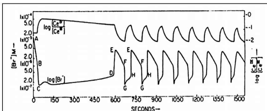
**OBRÁZEK 1:** Závislost signálů  $\text{Br}^-$  ISE a oxidačně redukční Pt elektrody na čase.
