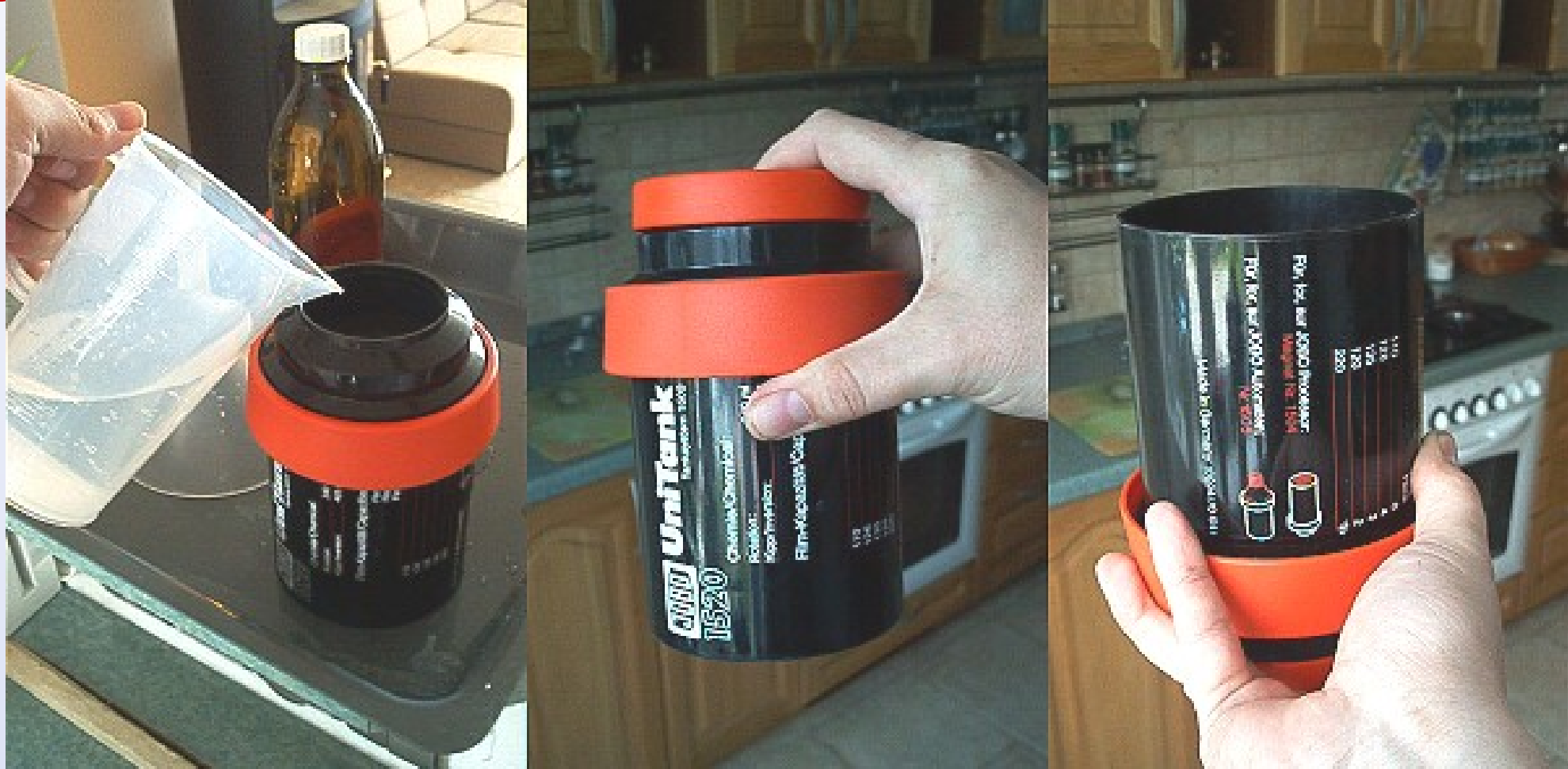
Nalítí vývojky a překlápění (příp. otáčení cívkou)
