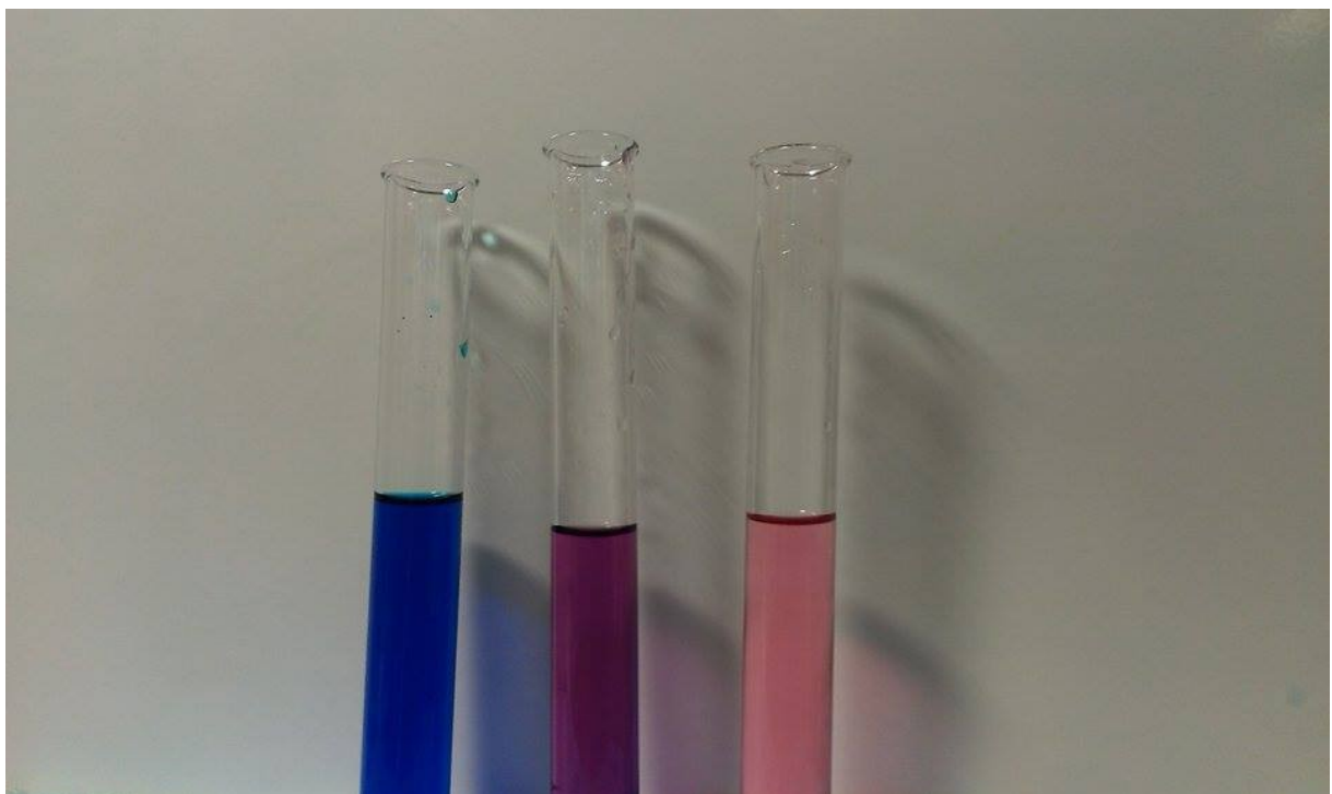
Obrázek 1: Porovnání barev komplexních sloučenin kobaltu při změně koncentrace
