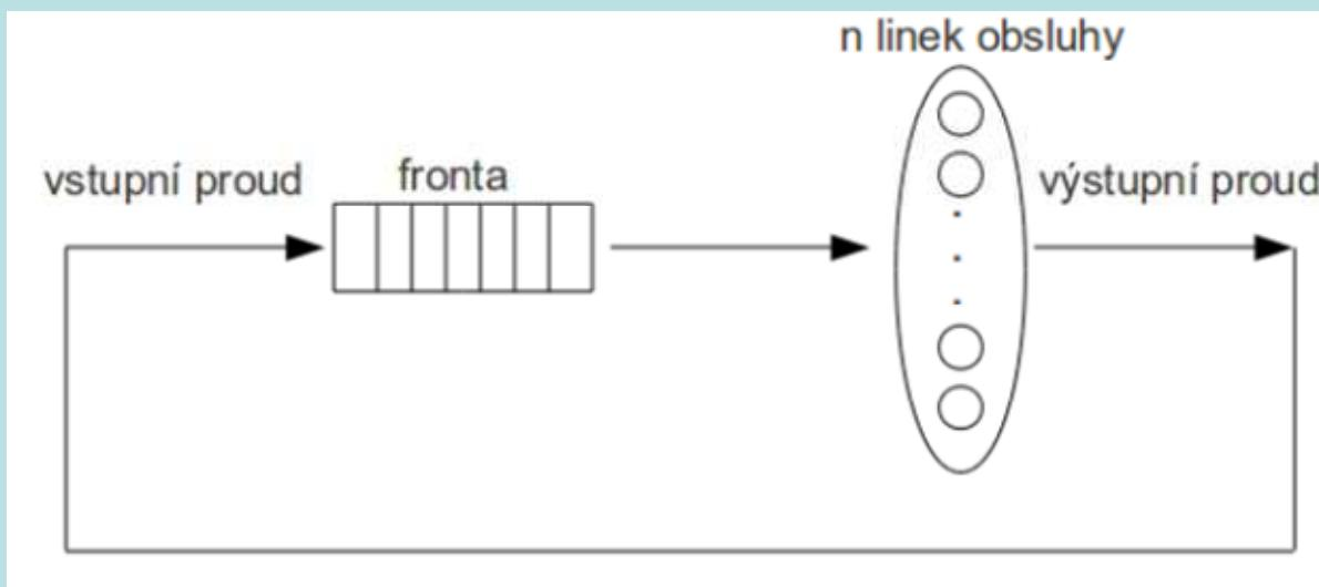
Doba pobytu každého zákazníka mimo systém má rozložení  $Ex(\lambda)$ , doba obsluhy u každé z n linek obsluhy se řídí rozložením  $Ex(\mu)$ .
