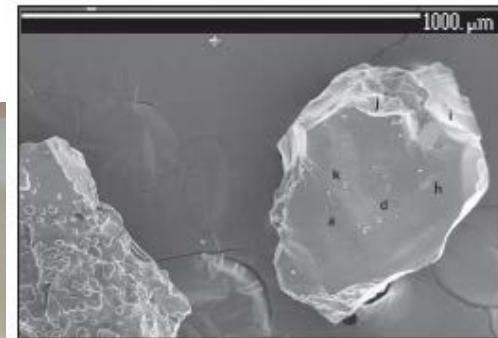
Obr. 2 – Nejčastější tvary vyskytující se na povrchu zrna: a – lasturnatý lom, d – puklinové plochy, h – srpkovité tvary, j – rovné brázdy, j – obloukové brázdy, k – přilnavé částice. Vzorek sedimentu mury; údolí Bělého Labe, Krkonoše.
