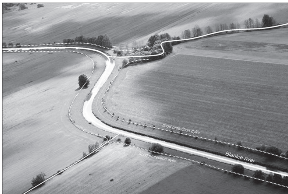
Obr. 5 Napřímené koryto Blanice na dolním toku s protipovodňovými valy. Ochranné hráze, chránící zde zemědělskou půdu, brání efektivnímu využití retenčního potenciálu ploché údolní nivy pro pasivní protipovodňovou ochranu. Foto J. Langhammer, 2005.
