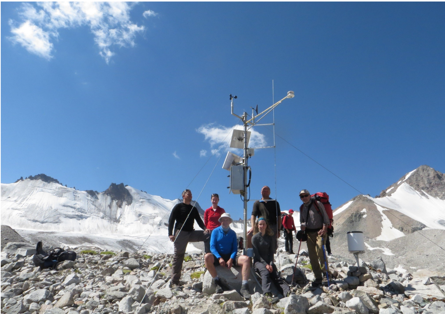
Klimatická stanice Adygine, 3700 m n.m., se satelitním přenosem, instalace červenec 2017
