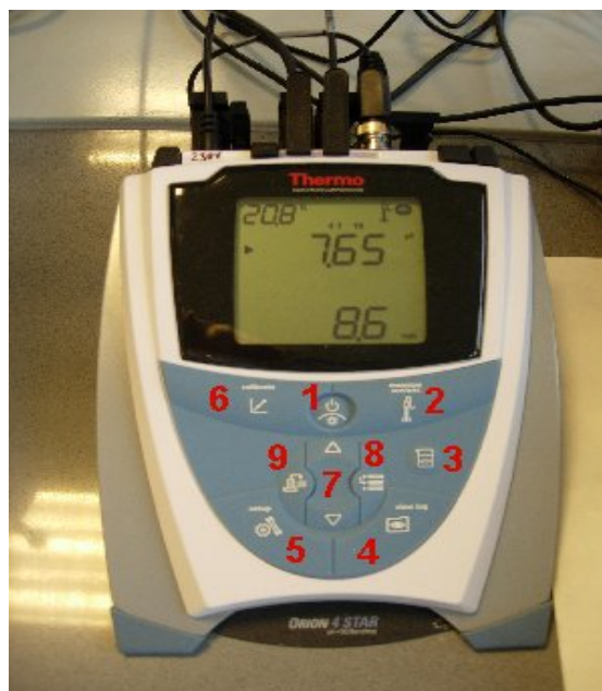
Obr. 1.: Základní funkce a rozvržení kláves přístroje. 1...Zapnutí, vypnutí a osvětlení displeje. 2...Měření. 3...ovládání míchadla. 4... Prohlížení dat. 5...vstup do režimu nastavení přístroje. 6...kalibrační režim. 7... posuv v nabídce. 8... výběr řádku na displeji. 9...horizontální výběr pozice.
