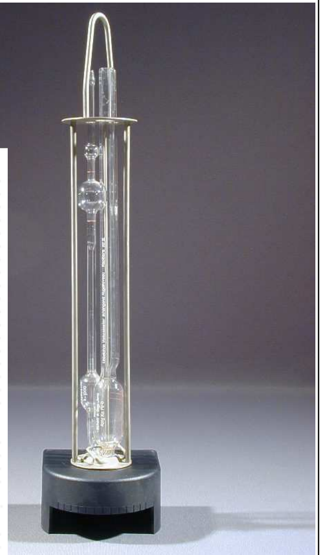
Obr. 90 Ubbelohdův kapilární viskozimetr V – objem určený k průtoku, R – dutina k volnému výtoku kapaliny, D – odvěšovací trubice, K – kapilára
