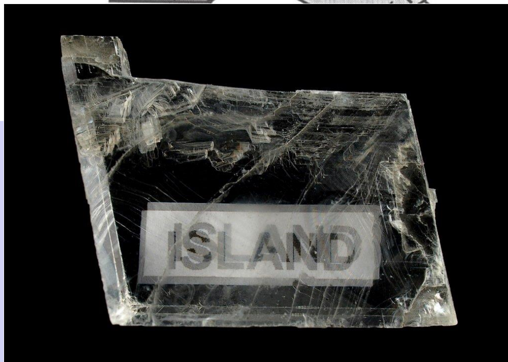
Obr. 13 Rozdíl mezi lomem a dvojlomem.
