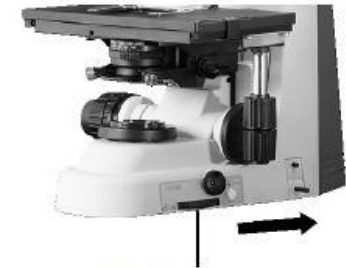
Otáčením kolečka clony zorného pole zacroňte clonu co nejvíce
