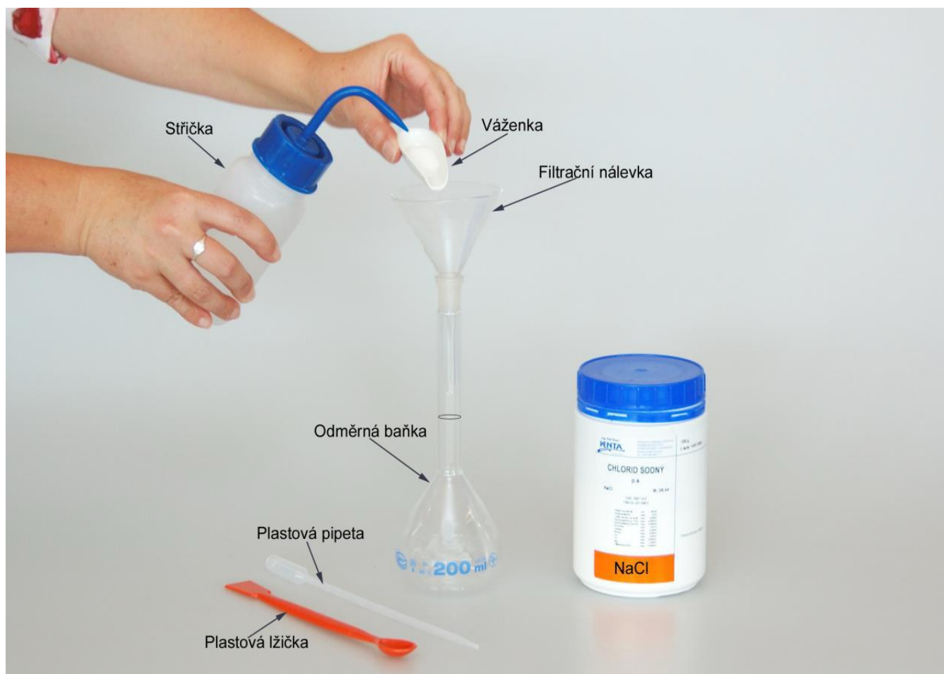
Obr. 7 Ukázka techniky splachování vzorku do odměrné baňky
