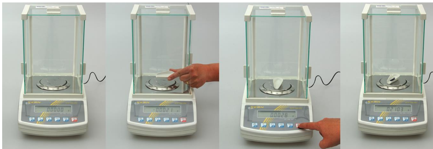
Obr. 7 Ukázka vážení na analytických vahách
