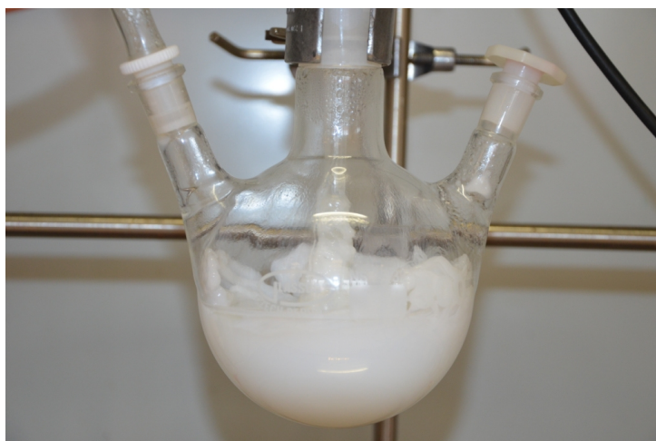
Obr. 5.3: Nežádoucí výsledek polymerace vypnuté v průběhu reakce
