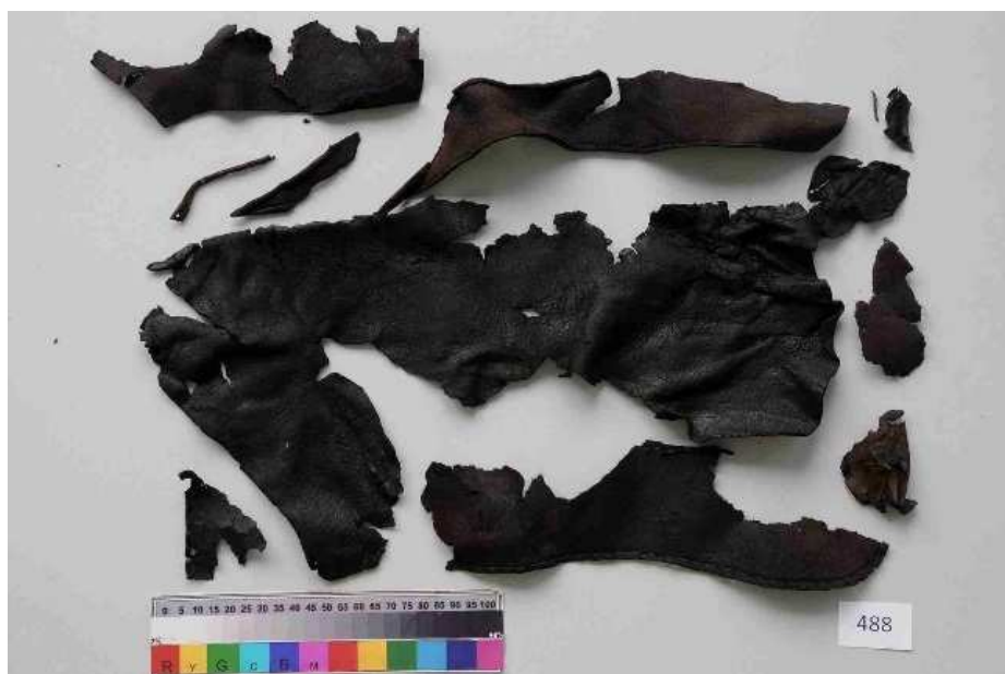
Obr. 8-14: Umytá a lehce osušená useň před konzervací [MŘ]
