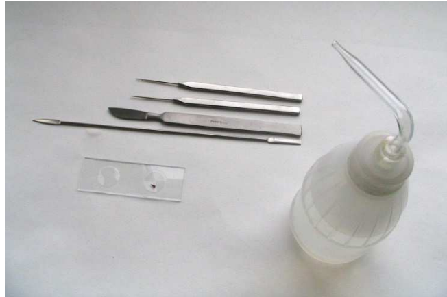
Obr. 5-15: Příprava ke zkoušce soudržnosti materiálu a pro měření T_s mikroskopicky [MS]
