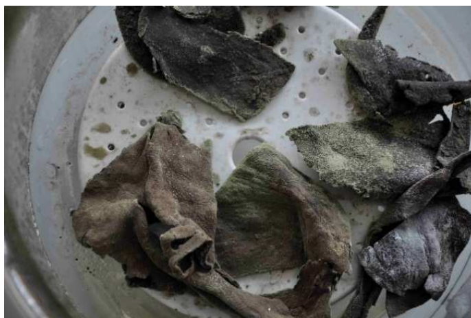
Obr. 8-7: Růst plísní v prostředí o vysoké RH, bez přídavku biocidu [GV]
