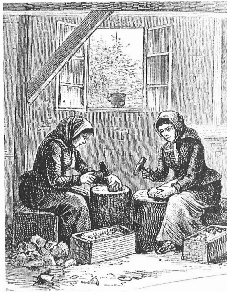
1 Úprava křemene v 19. století. Ženy rozbíjejí vypálené kusy křemene a odstraňují železité, zbarvené žilky.
