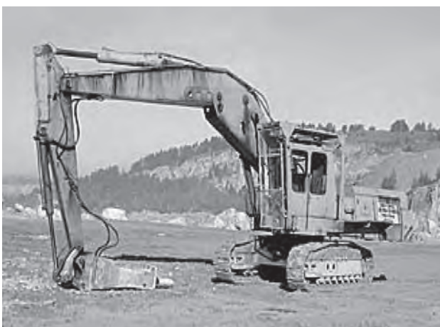
Obr. 1 Pneumatické kladivo na pásovém podvozku k rozdužování horniny a k rozbíjení větších kusů vápence
