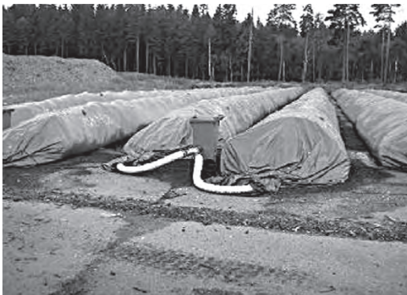
Obr. 13 Kompostovací vaky AG-BAG v provozu na kompostárně ve Švédsku
