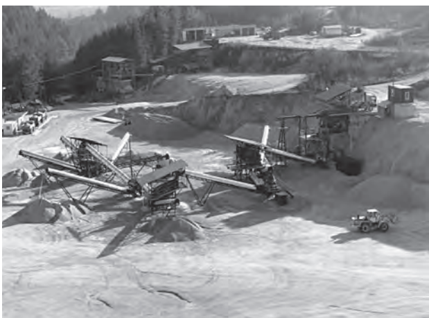
Obr. 7 Úprava a třídění natěžené horniny
