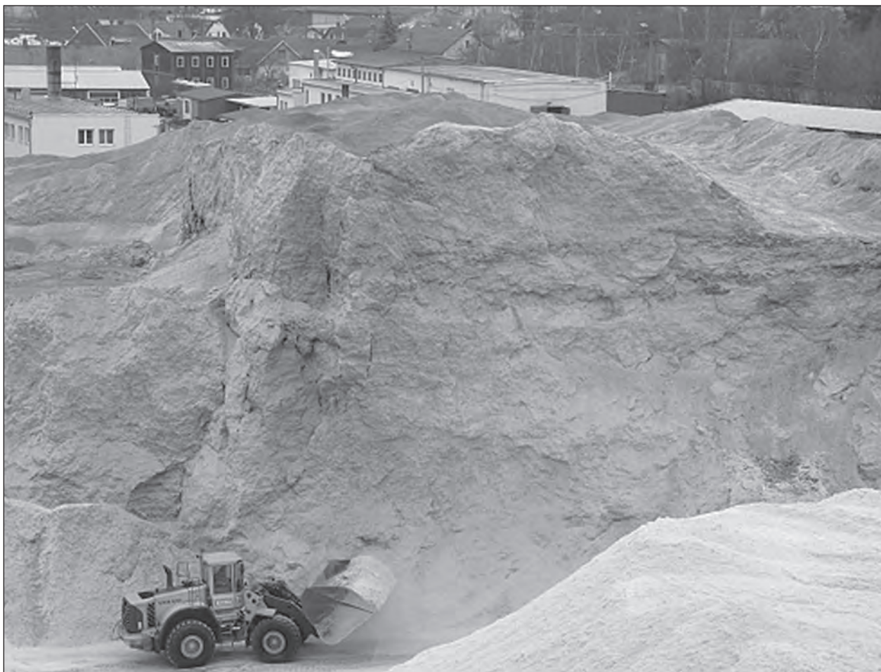
Obr. 2 Skládka pilin s čelním nakladačem Volvo řady 220 a lžící 15 m 3
