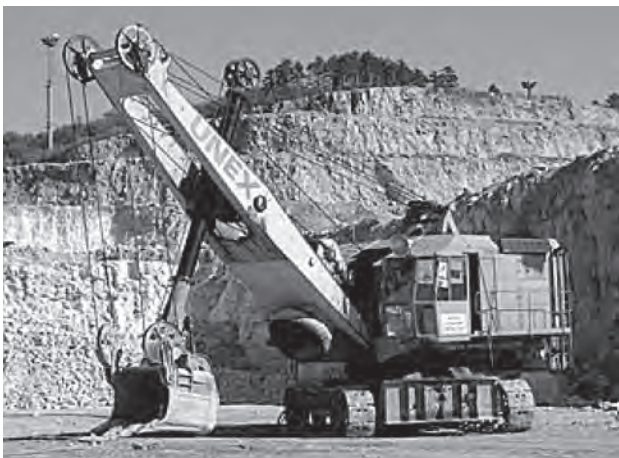
Obr. 3 Elektrické rýpadlo k nakládání materiálu
