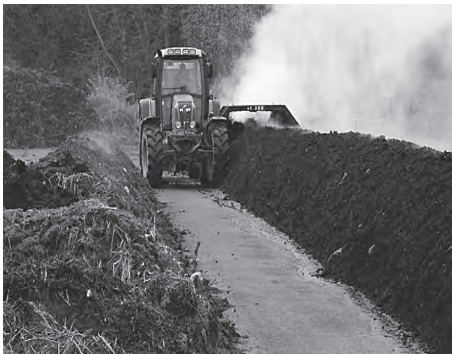
Obr. 12 Překopávání hromad připojitelným překopávačem
