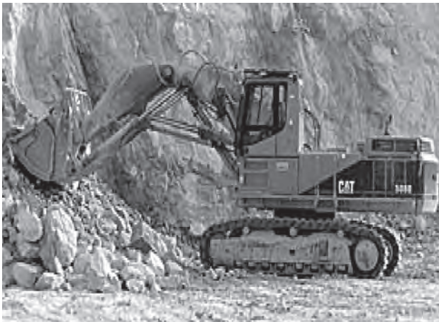
Obr. 5 Hydraulické pásové rýpadlo k nakládání materiálu při těžbě, vybavené ocelovou koulí pro rozbíjení nadměrných balvanů
