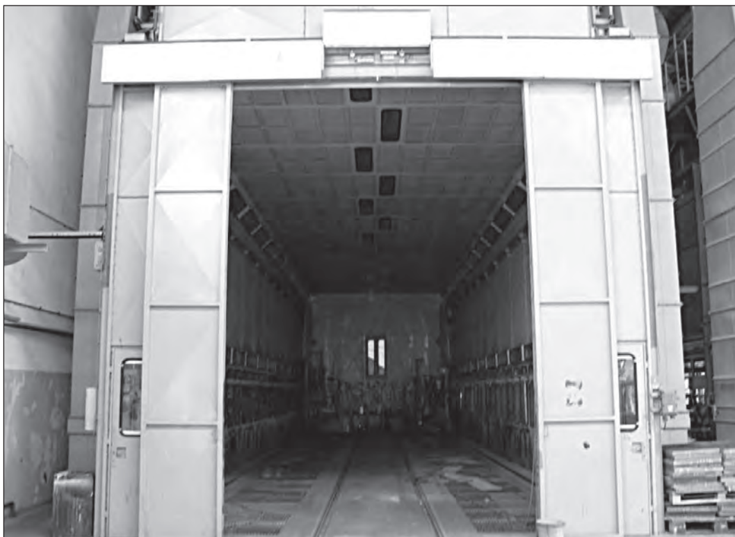
Obr. 6 Pojezdová stříkácí kabina pro povrchovou úpravu kolejových vozidel
