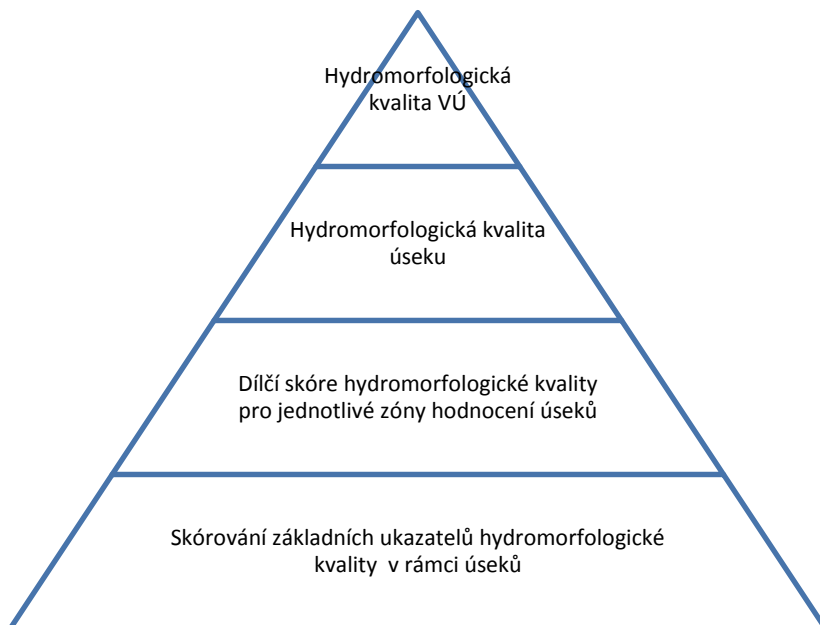
Obrázek 4 Hierarchický princip hodnocení hydromorfologické kvality v rámci metodiky HEM
