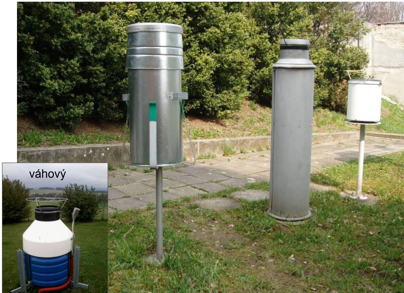
Srážkoměry používané v síti stanic ČHMÚ: vlevo – Metra 886, uprostřed – ombrograf, vpravo – automatický srážkoměr (foto J. Záruba)
