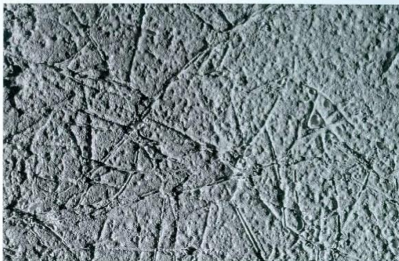
Obr. 18. Matrice vytvořená pomocí hmoty Microsil™. Foto H. Eliášová. Fig. 18. Matrix created with the aid of a Microsil™ ma- terial.
