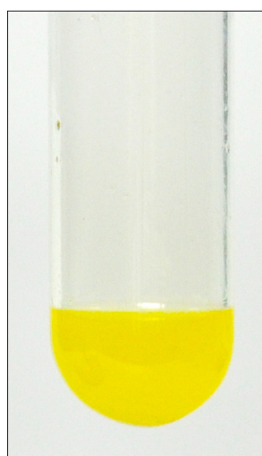
Obr. 6: Žluté zbarvení rozpuštěného galalitu
