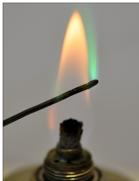
Obr. 9: Pozitivní reakce Beilsteinova testu
