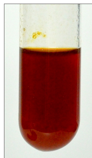
Obr. 7: Zbarvení roztoku galalitu po reakci s NaOH
