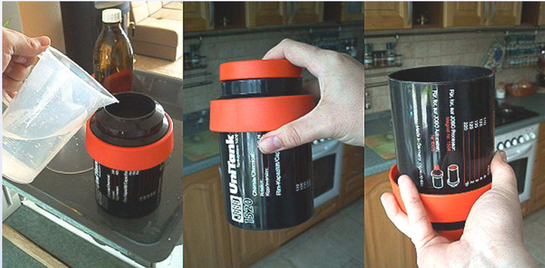
Nalítí vývojky a překlápění (příp. otáčení cívkou)
