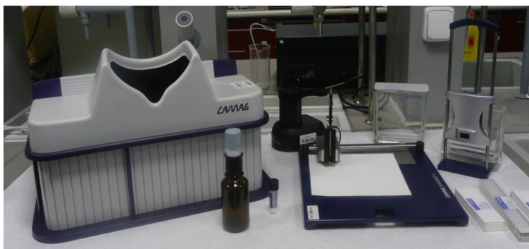
Obr. 68.3: Příklad uspořádání HPTLC sady od společnosti CAMAG
