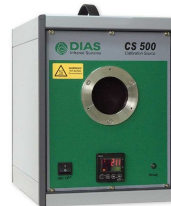
Kalibrační tzv. černé těleso
