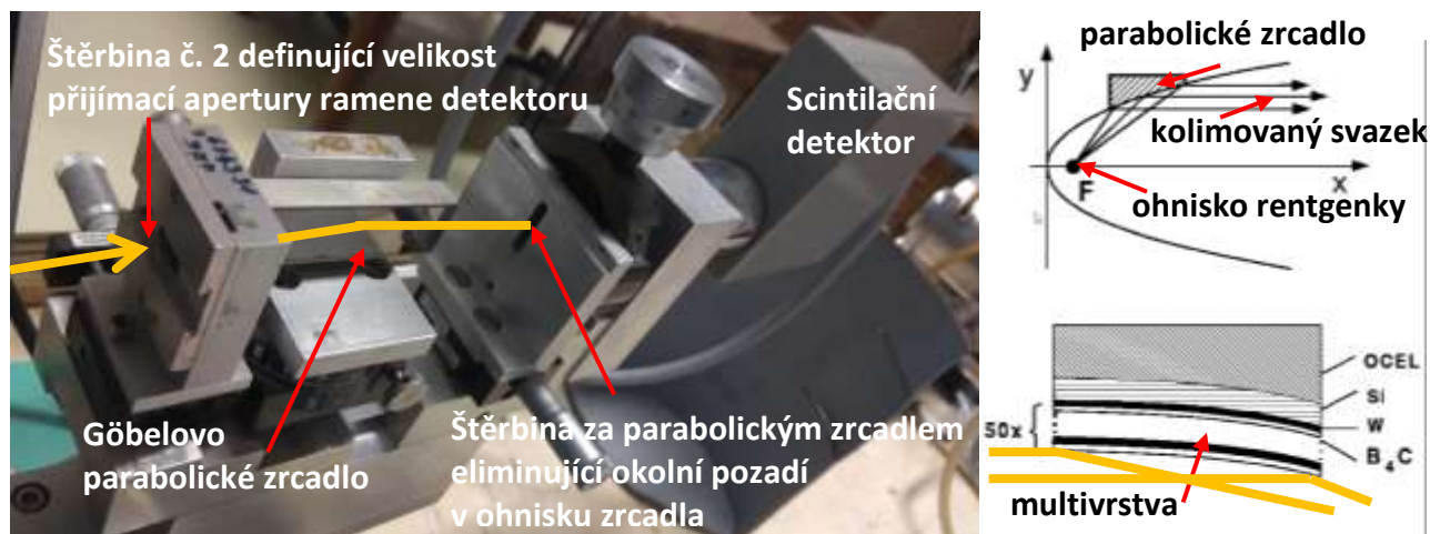
Obr. 6 Detail ramene s detektorem na němž jsou umístěny po řadě štěrbin vymežující tvar odraženého svazku, Göbelovo parabolické zrcadlo fokusující svazek do další velmi úzké štěrbině za zrcadlem a dále do scintilačního detektoru (vlevo). Schéma Göbelova multivrstevnatého parabolického zrcadla sloužící pro fokusaci resp. kolimaci a také monochmatizaci rentgenového záření (vpravo).
