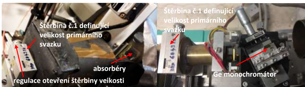
Obr. 5 Detailní pohled na štěrbinu tvarující primární svazek společně s olověným krytem krystalového monochromátoru a karuselu s řadou Al absorbérů (vlevo), Ge 2x(220) monochromátor s možností posuvu pod krytem mezi absorbéry a štěrbinou č.1. (vpravo).
