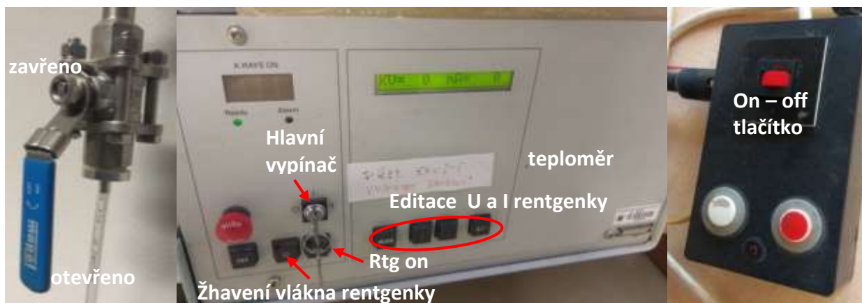
Obr. 3 Detail uzávěru rozvodu vakua pro uchycení vzorku a pro parabolické zrcadlo (vlevo), ovládání zdroje vysokého napětí pro rentgenku (uprostřed) a ovládání závěrky primárního svazku (vpravo).
