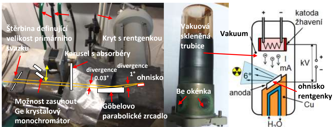
Obr. 2 Vlevo: Detail části difraktometru, kde se tvoří a formuje primární rtg svazek pomocí rtg lampy a rtg optických prvků; Vpravo: Fotografie rentgenové lampy bez krytu a schéma uvnitř.
