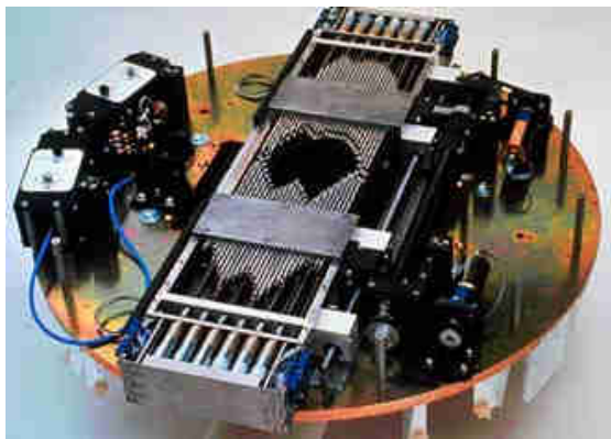
Obr. 192. Kolimátor pro IMRT terapii s měnitelným profilem pole.
