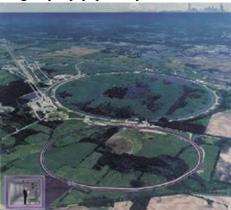
Obr. 40. Tevatron ve Fermilabu. Injektor je vpředu (3.2 km obvod) a produkuje částice s energií 150 GeV. Tyto částice jsou injikovány do Tevatronu - supravodivého protonového synchrotronu, který je schopen urychlovat protony a v opačném směru antiprotony (tzv. collider).
