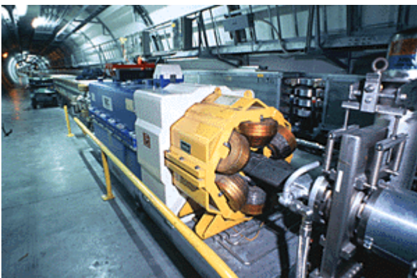
Obr. 38 Kvadrupolové čočky slouží k udržení svazku uvnitř urychlovací trubice (žlutě).
