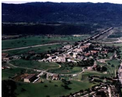
Obr. 34. Lineární urychlovač ve Stanfordu byl zkonstruován Burtonem Richterem a je 3 km dlouhý. Energie elektronů zde dosáhla v roce 1976 20 GeV.
