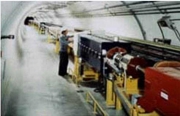
Obr. 37. Protonový synchrotron v CERNu urychluje částice na 450 GeV. Ohýbající magnety jsou červené, fokusující modré.
