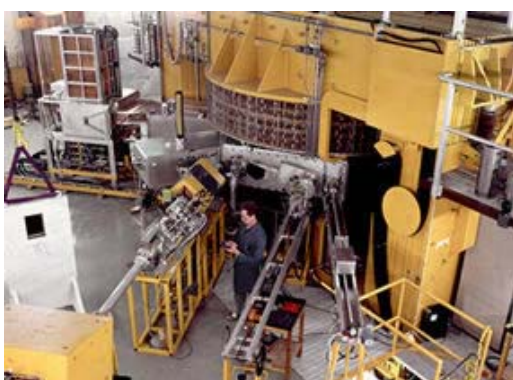
Obr. 36. Cyklotron v Upsale (Švédsko) byl postaven po válce (1950) a urychluje protony na energii 185 MeV. Vakuová komora je vidět pod magnetem (žlutý) vážícím 600 tun. Výstupní kanály směřují dopředu. Urychlovač byl v roce 1986 přestavěn na cyklotron se sektorovou fokusací.
