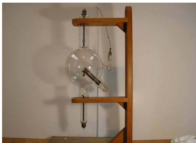
Obr. 21. Roentgenovo záření vzniká v rentgence při dopadu elektronů na anodu nebo antikatu. Většinou anoda slouží pro vytvoření elektrického pole a do lampy se vkládá další elektroda – antikata pro dopad elektronů, kde se tvoří záření. Dole je anoda, nahoře katoda, uprostřed antikata odkud vychází záření. Schéma lampy je zobrazeno na horním obrázku, dole je reálná Roentgenova lampa (historický exemplář).
