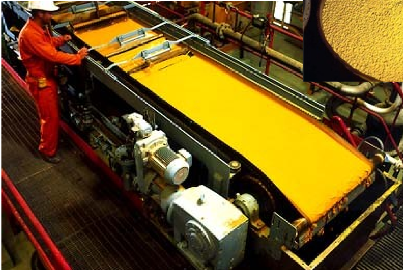
Obr. 9, 10: Zpracování uranové rudy na tzv. „žlutý koláč“ – výrobní linka a konečný poloprodukt. [6,7]
