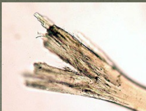
poškození způsobené skleněnými střepy
