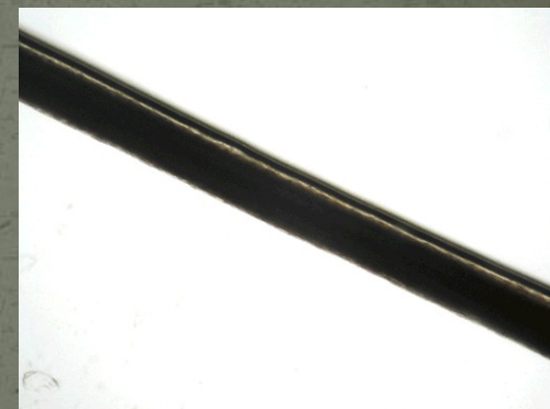
poškození způsobená konc. NaOH
