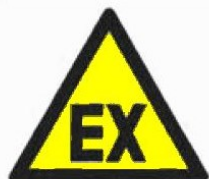
Nebezpečí – výbušné prostředí
