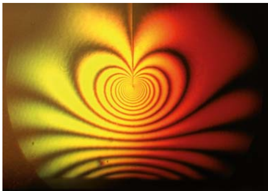
Obr. 9 Interferenčné čiary v okolí trhliny.
