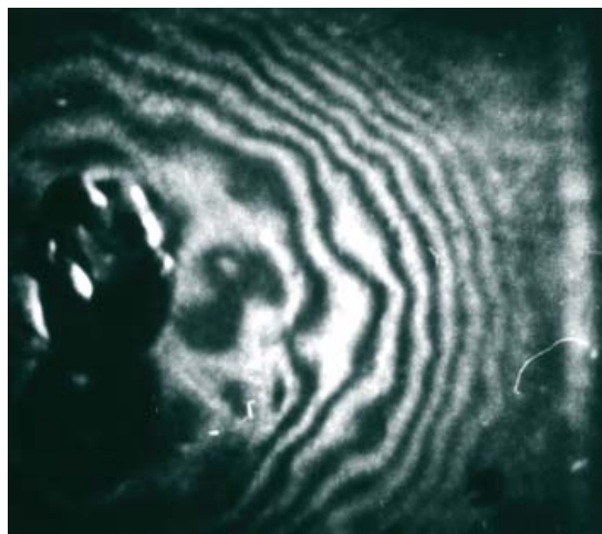
Obr. 4 Vizualizácia napätvej vlny šíriacej sa na povrchu rýchlosťou 3800 m/s.
