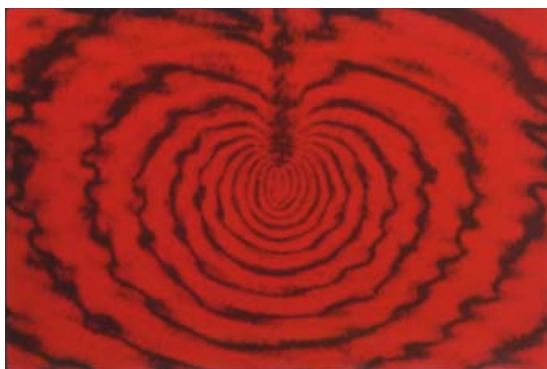
Obr. 2 Obrázok interferenčných čiar rovnakej zmeny hrúbky (izopachických čiar) v bezprostrednom okolí špičky trhliny pri jej mechanickom namáhaní.
