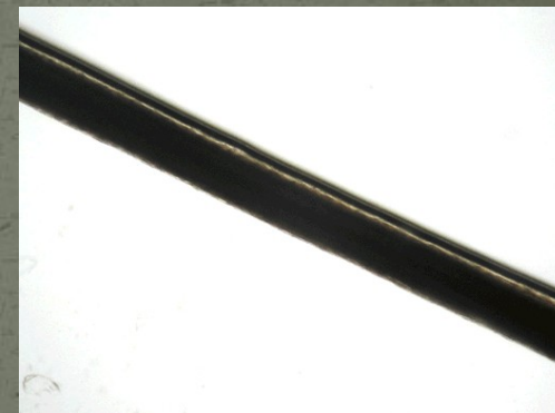
poškození způsobená konc. NaOH
